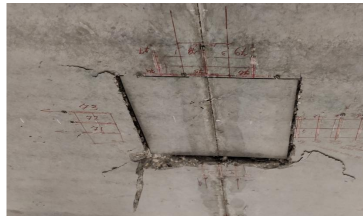
Характер разрушения сжатого бетона в окрестности опирания плит.
