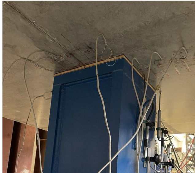
Общий вид бетона в окрестности опирания плиты до разрушения (слева); после продавливания образца (справа).
