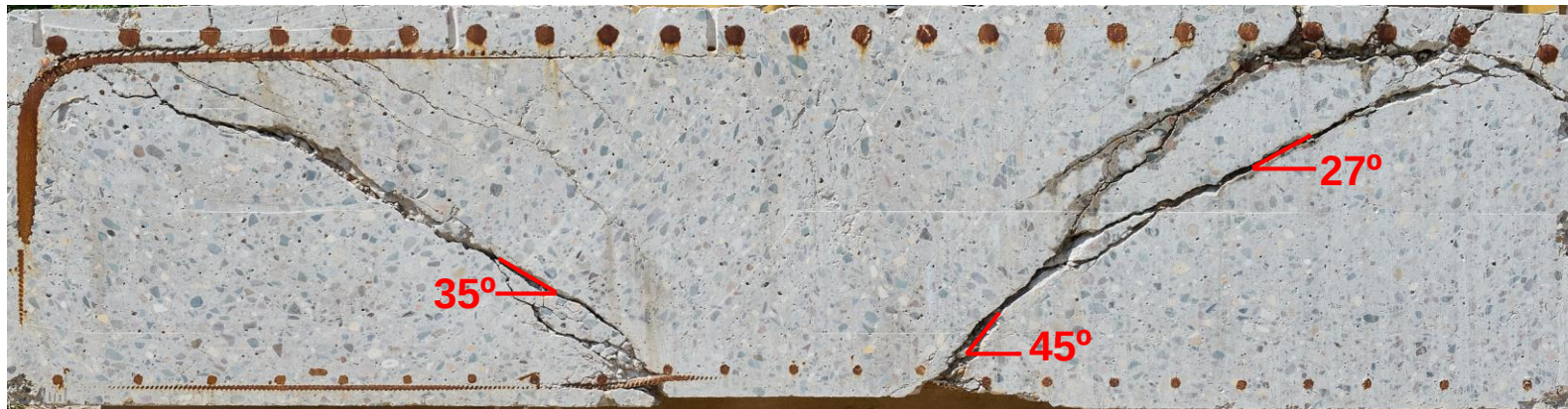
Характер разрушения плиты марки ККТ_1_№1.
