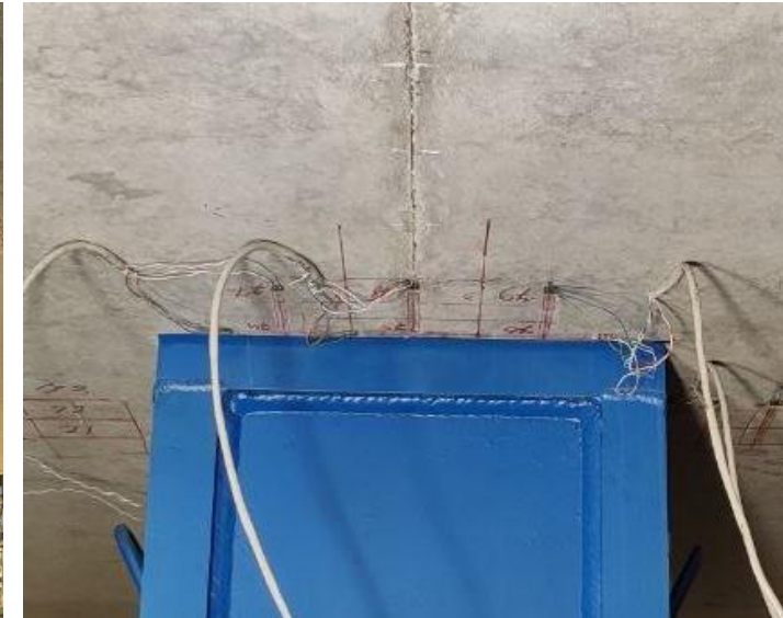
Общий вид бетона в окрестности опирания плиты до разрушения (слева); после продавливания образца (справа).
