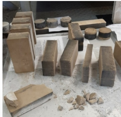
Образцы геополимеров в возрасте 28 суток и их внутреннее строение (вибрационное уплотнение)
