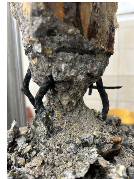
Испытания колонн на центральное сжатие: а) без коррозии; б) с коррозией
