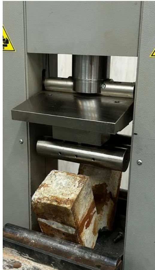
Испытание бетона на растяжение при изгибе
