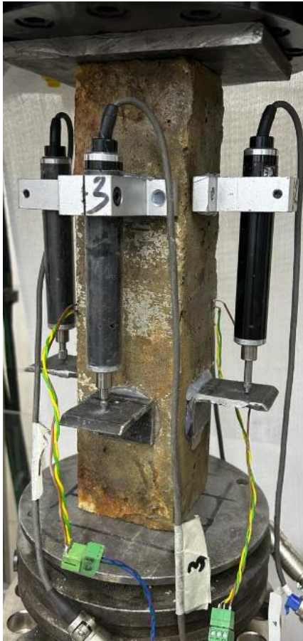
Испытание бетона на сжатие
