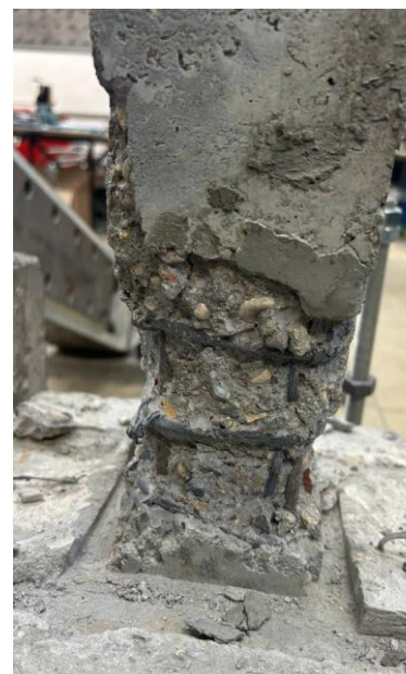
Испытания колонн на центральное сжатие: а) без коррозии; б) с коррозией
