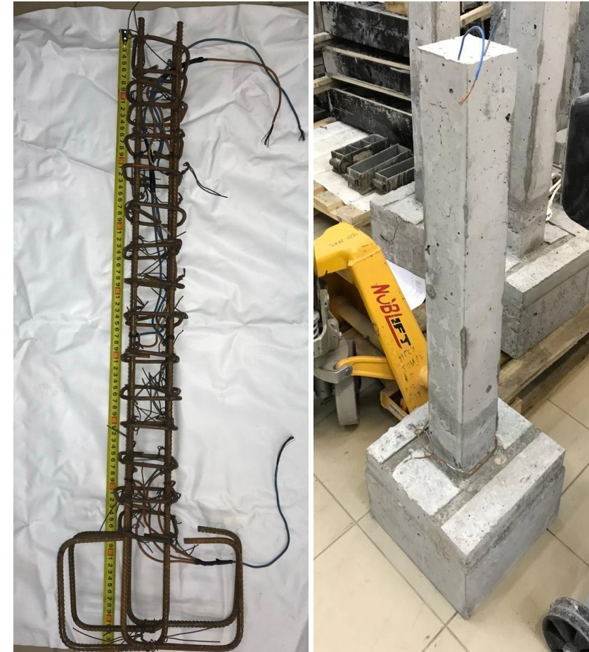
Экспериментальные образцы колонны
