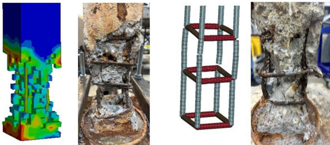
Характер разрушения колонн в ПК LS-DYNA и экспериментальных образцов
