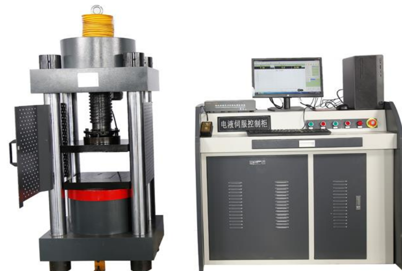
Рис. 1.12. Стандартные равновесные испытания бетонных образцов по ГОСТ 29167-91 в испытательной машине со следящей системой и быстродействующей обратной связью: 1 – пластины испытательной машины; 2 – опытный образец; 3 – индикаторы часового типа; 4 – контрольно-измерительное устройство, фиксирующее перемещения пластин испытательной машины; 5 – обратная связь; 6 – блок управления; 7 – прямая связь
